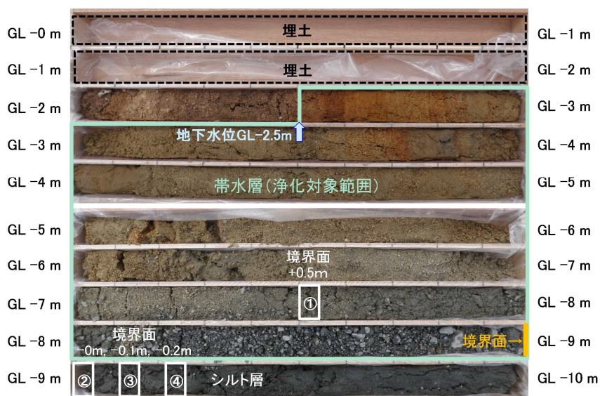
帯水層とシルト層の境界面を基準にして土壌採取深度を決定
