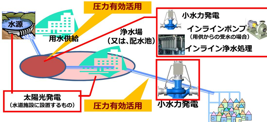
標高の高い水源から取水して浄水場等に取り込む際、通常は圧力を開放するため、圧力がロスになる。密閉（インライン）のまま、小水力発電設備を設置し、送水動力・浄水処理工エネルギーに活用。
