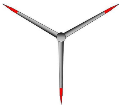
図-8 3枚のブレードの彩色例 (赤色、先端部彩色)
