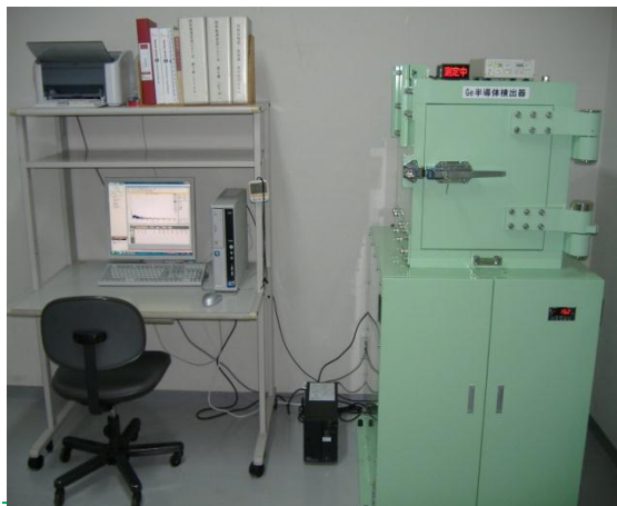
図3-4-1 ゲルマニウム半導体検出器 ガンマ線スペクトロメータの例
