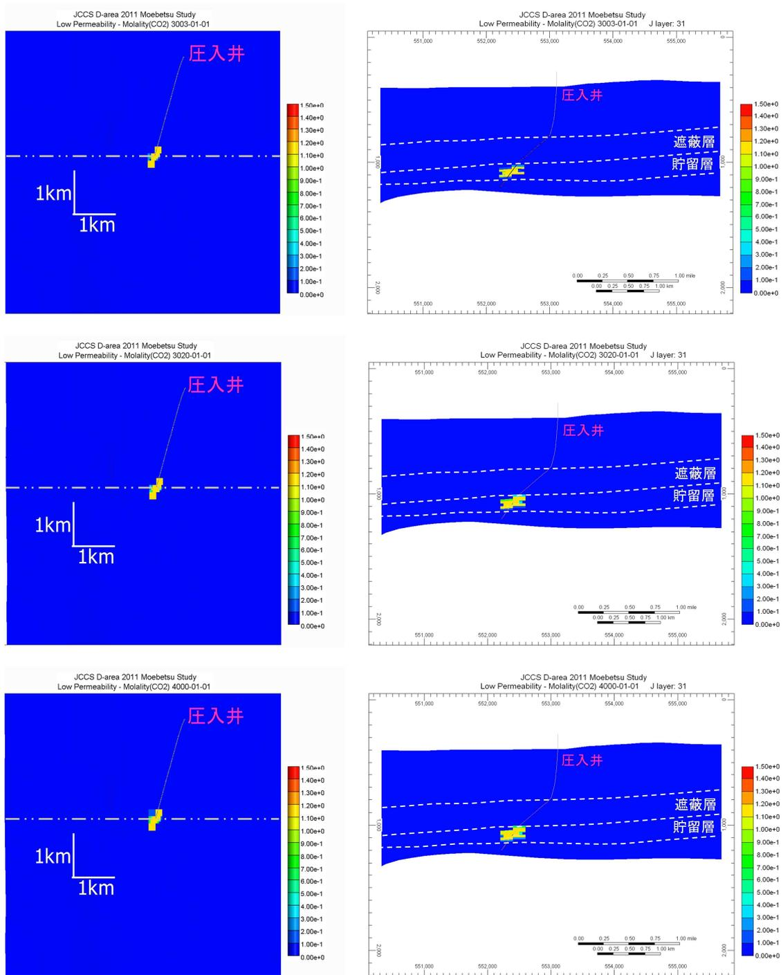
注: 上段: 3年後, 中段: 20年後, 下段: 1,000年後。左側: 平面分布 (k 方向セル 28), 右側: 東西断面 (位置は平面分布の点線的位置)。単位は, mol/kg。
