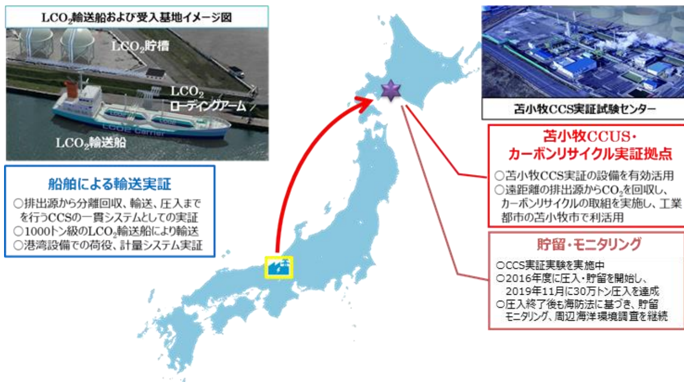
7 図 10 排出源と再利用・貯留の集積地とのネットワーク最適化と液化二酸 8 化炭素船舶輸送（ハブ&クラスター） <出典> 経済産業省
