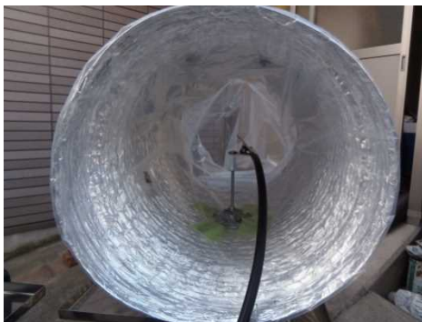
図 3.124 チューブ配管を使用した場合の排気ダクトの測定例
