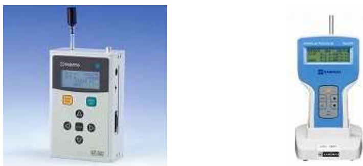
図 3.128 パーティクルカウンターの例
