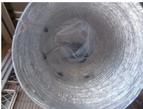
図 3.125 等速吸引ノズルを使用した場合の排気ダクト内の測定例
