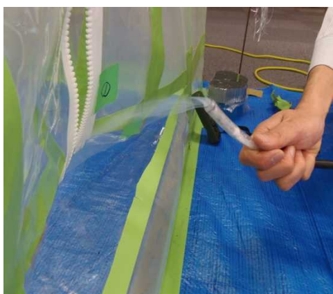
図 3.121 スモークテスターによる確認
