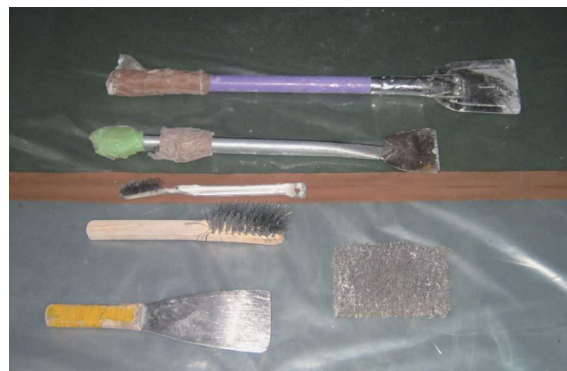
図 3.55 除去作業用の手工具の例
