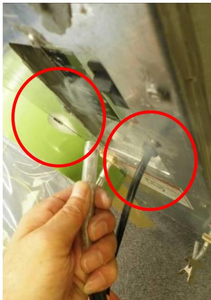
スイッチ等の取り付け部、電源コード取り付け
