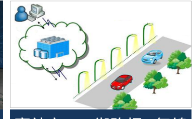
高効率LED街路灯の無線 制御（ミネバア）
