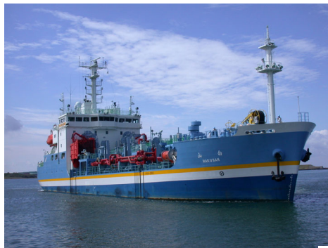
大型浚渫兼油回収船「白山」 (浚渫方法：ドラグサクシオン式)
