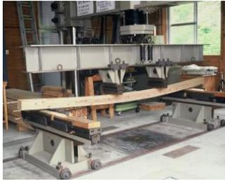
普通構造材(杉材)の繊維方向の許容応力度
