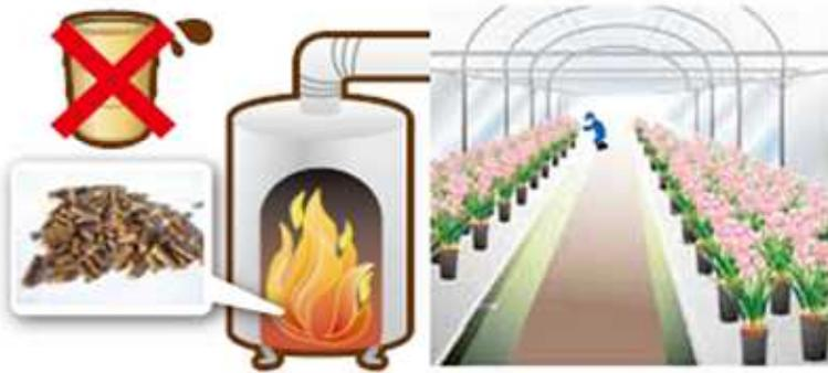
重油などの「化石燃料」の代わりに「木質ペレット」(木質バイオマス)を燃焼させハウスを加熱し農産物を栽培
