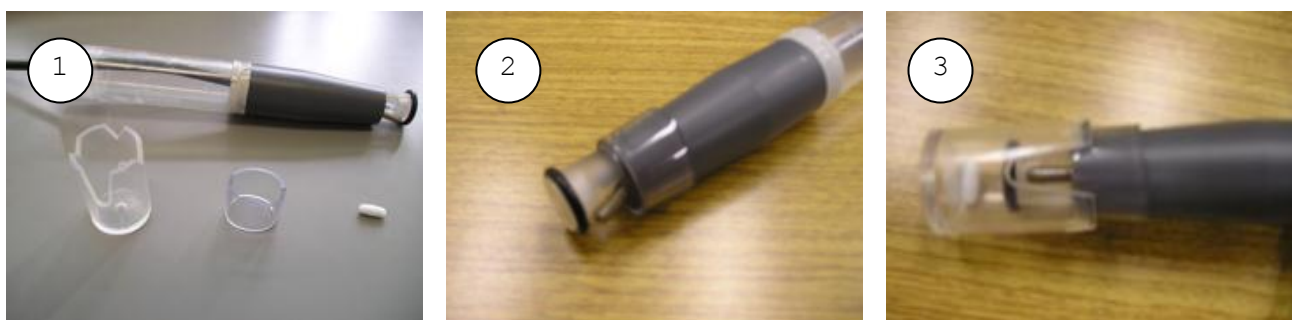
Fig. 1 ①電極、穴あきキャップ、円形カバーガラス、ビニールチューブ、回転子を用意。②ビニールチューブを電極に取り付け、キャップとの間のガスケットとする。③円形カバーガラスと回転子を入れた穴あきキャップを、温度センサーに被さないように電極に取り付ける。
