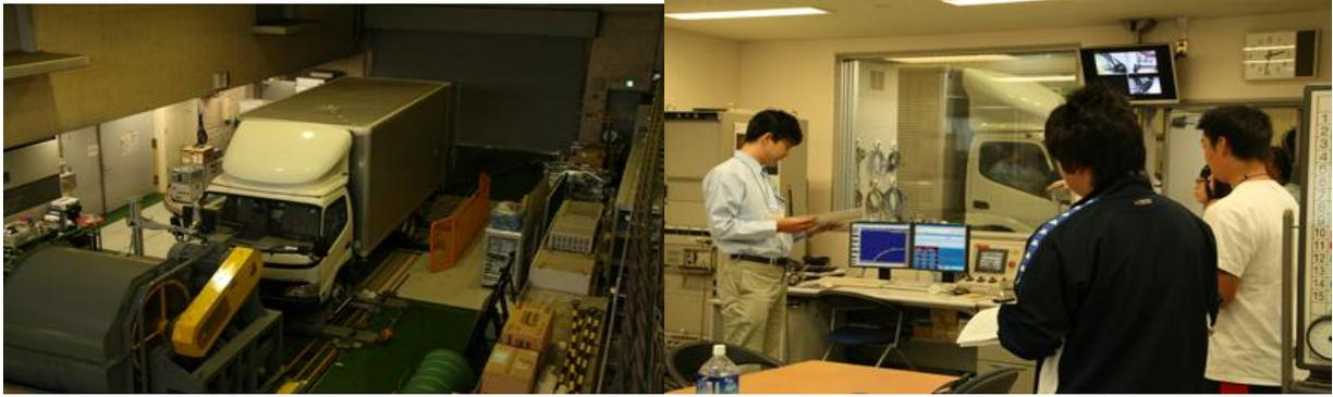
シャーシダイナモを用いた車両試験の見学、排出量計算
