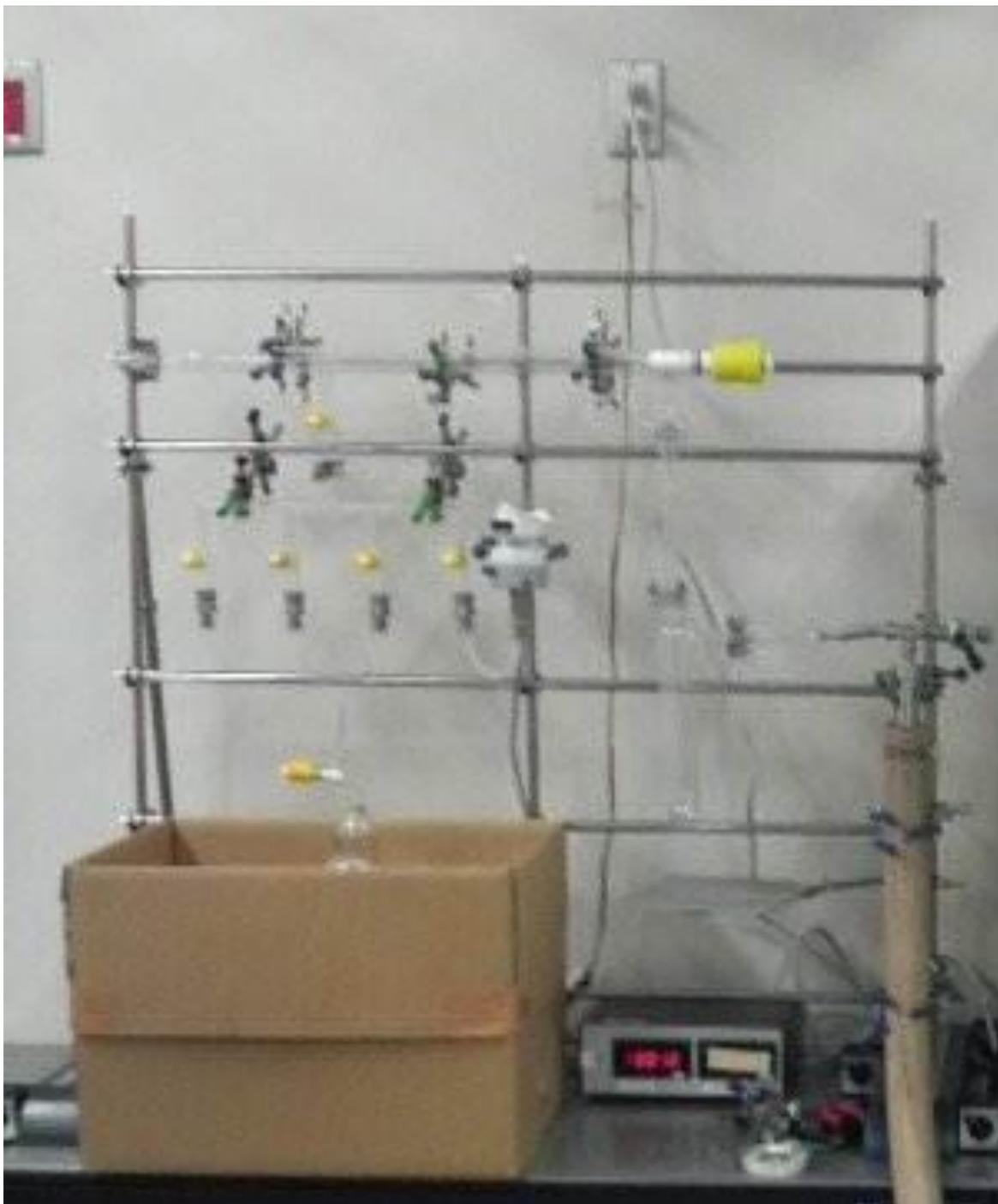
図(1)-31 FT-IRにて吸光度計測のためのサンプル作成に使用したガスハンドリングライン。写真中のダンボール箱に入っているのはガス玉。
