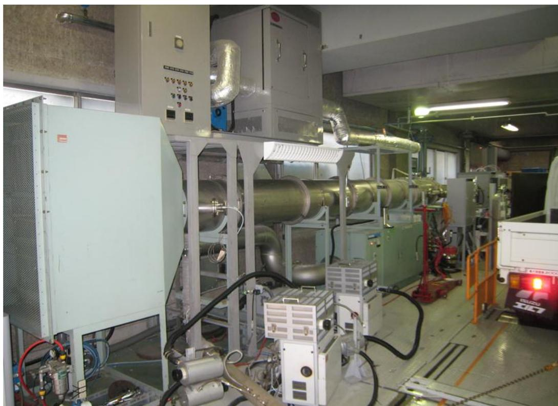
図(2)- 42 全量希釈装置(CVS)写真
