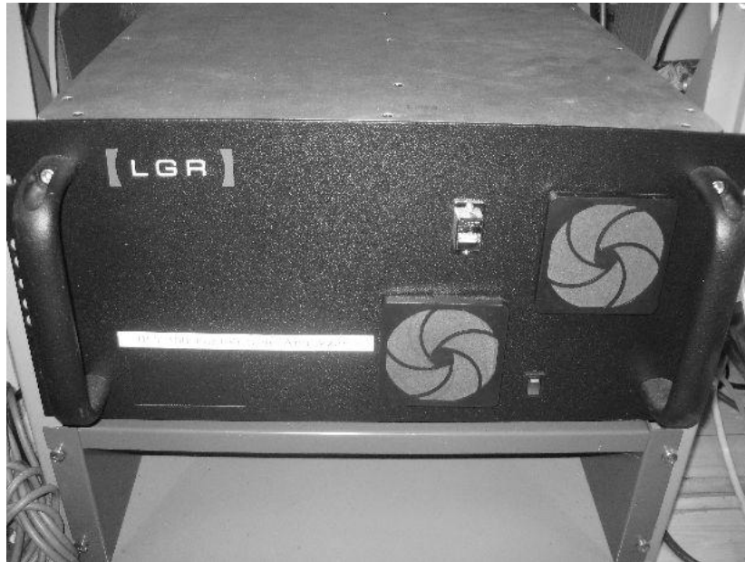
図 - 2 高速メタン計 (DLT-100, Los Gatos Research)
