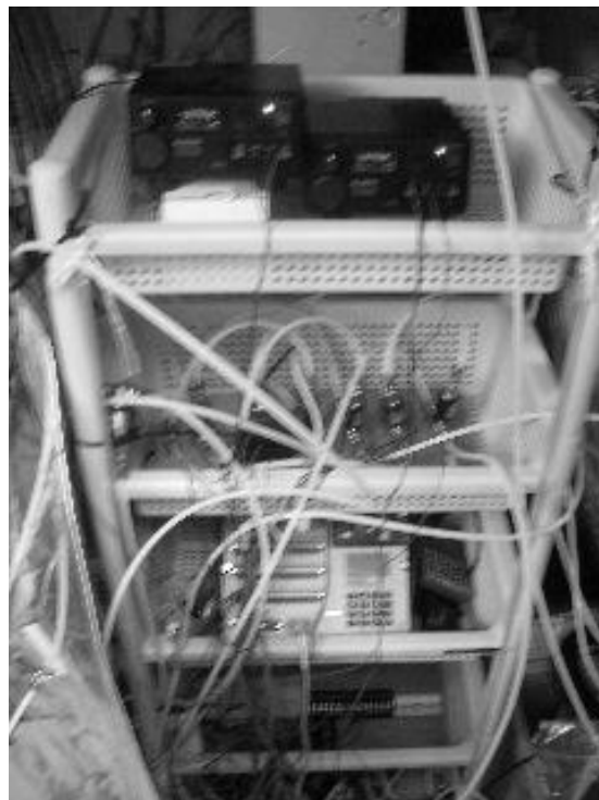
図 - 7 REA法フラックス観測システムの中央制御ユニット
