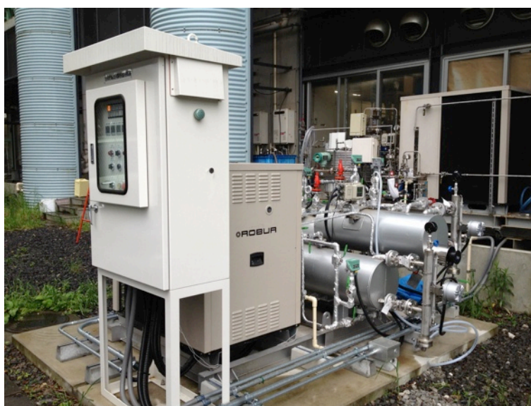
図2 溶液貯蔵タンクを持つ蓄熱実験装置
