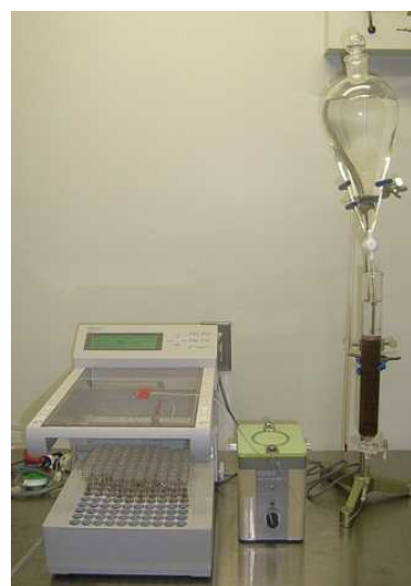
図 4.15 カラム溶出実験
