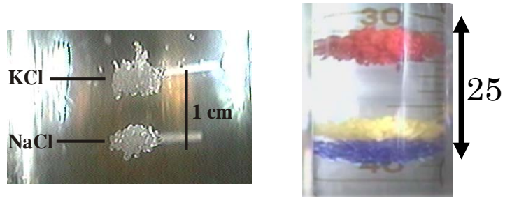
図-2 2 磁気アルキメデス分離の実例
