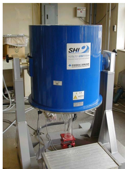
図-19 普及型の伝導冷却式超伝導磁石の外観 本装置は最大印加磁場 12 T で室温の 100 mm φ のボア空間を有する
