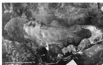
(taken by Bandung Institute of Technology) (堆積高さ 60~70m。斜面勾配 30~45° の堆積地で 3 日間の激しい降雨後に崩落。)
