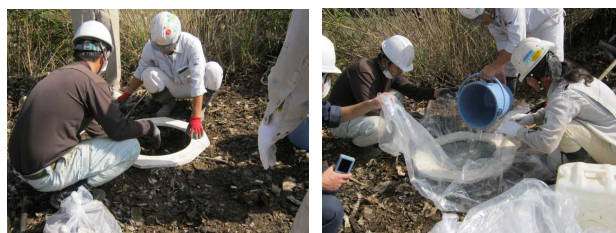
写真 3.2.17 水置換による廃棄物層密度試験
