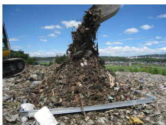
図 5 「不法投棄等現場の堆積廃棄物の斜面安定性評価マニュアル(案)」に示した主な試験法 (左: 安息角試験 中: 作成した現場一面せん断試験機 右: 衝撃加速度試験)
