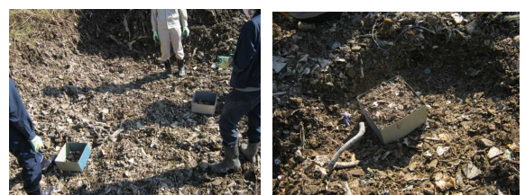
写真 3.2.15 試料採取位置の選択及び供試体の成形
