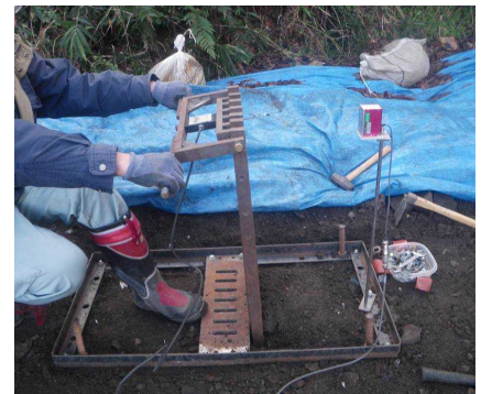
写真 3.2.13 現場土圧試験の実施状況
