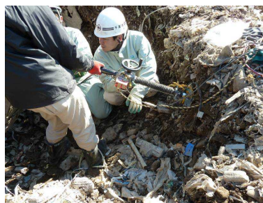
図 3.2.23 現場引抜試験と引抜変位-引抜力の結果
