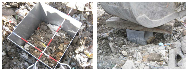
写真 3.2.16 試料採取試験器及び重機による打ち込み
