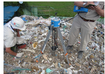
図 5 「不法投棄等現場の堆積廃棄物の斜面安定性評価マニュアル(案)」に示した主な試験法 (左: 安息角試験 中: 作成した現場一面せん断試験機 右: 衝撃加速度試験)
