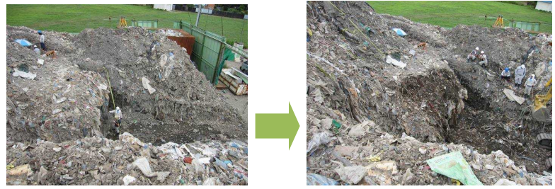
写真2 不法投棄等現場（中部地方）での崩壊実験 （左写真：矩形トンネル状の掘削 右写真：崩壊後）
