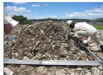
写真 3.2.10 鉛直上方からの载荷実験後(中部①・繊維状物等多)
