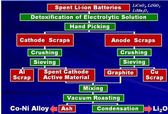
図3 提案するプロセスフロー
