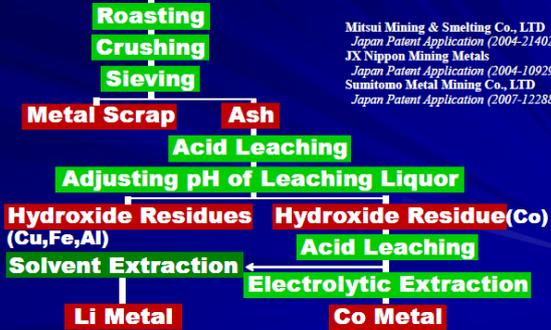
図2 湿式法による従来のリサイクルプロセス
