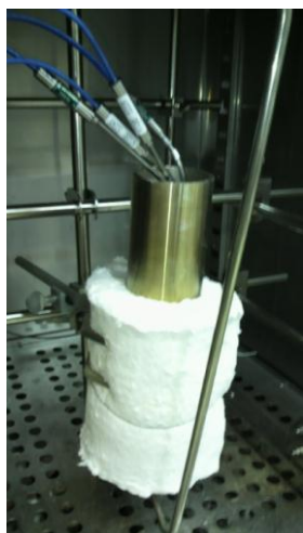
図3 土壌加熱槽の様子
