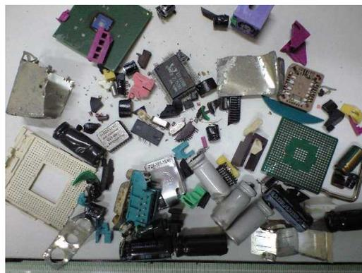
写真1 PC基板水中爆破後の剥離部品
