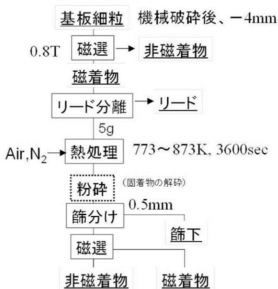
図 9 破碎基板細粒からの Ni 分離試験フロー
