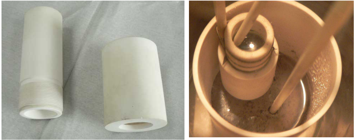
図 4.7 試作したマコール加工品と使用中の様子。
