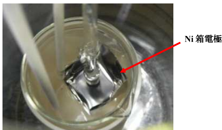
図 4.2 塩を入れる前の実験装置外観
