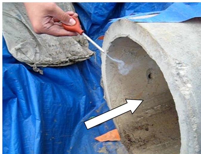
**図 6.3.4 浸出水集排水管出口における空気流入確認試験**
