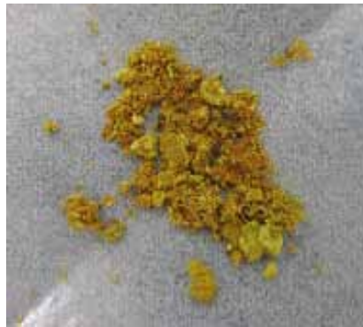
Fig. 35 塩化揮発後に反応管に析出した揮発物の外観
