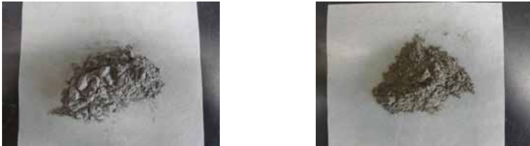
Fig. 1 実験試料の外観 [左：粉碎基板、右：基板焼却灰]
