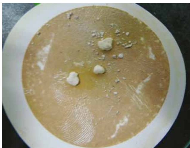
Fig. 43 模擬揮発物を溶解した際のろ過後残渣の外観（溶媒：純水）
