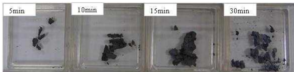
図 4-23 Na=250mg/L 電解液 (Pb=4 g/L) での定電流電解における Pb 電析物表面 (カソード) の 外観写真
