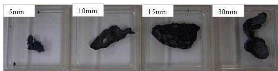
図 4-25 Na=100mg/L 電解液 (Pb=4 g/L) での定電流電解における Pb 電析物表面 (カソード) の外観写真
