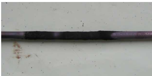
図 5.131 トルエンの部分酸化反応の使用後の写真 (コバル) 1173K
