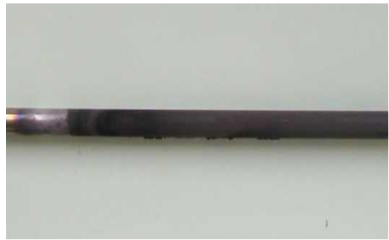
図 5.50 トルエン水蒸気改質後の触媒 (ハステロイ)
