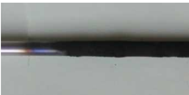
図 5.79 ナフタレン水蒸気改質反応後の反応管 (ト ルエン：ナフタレン=100 : 1) (ハステロイ)
