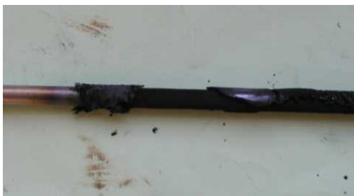
図 5.127 テトラデカンの部分酸化反応の使用後の写真 (コバル) 1173K
