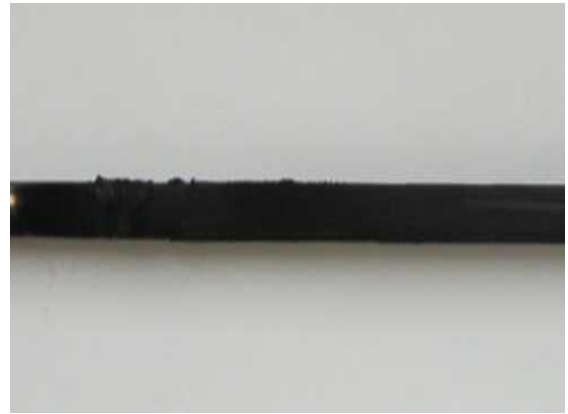
図 5.49 トルエン二酸化炭素改質後の 触媒(ハステロイ)
