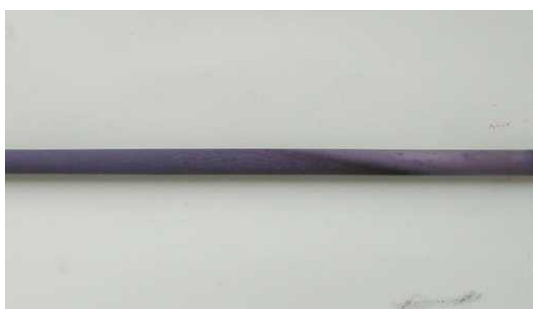
図 5.143 ナフタレン：トルエン (1 : 100) の二酸化炭素改質反応の使用後の写真 (コパール)
