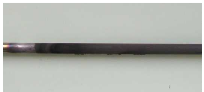
図 5.83 トルエン水蒸気改質反応後の反応管(ハステ ロイ)
