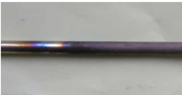
図 5.78 ナフタレン水蒸気改質反応後の反応管 (ト ルエン：ナフタレン=100 : 1) (ハステロイ)
