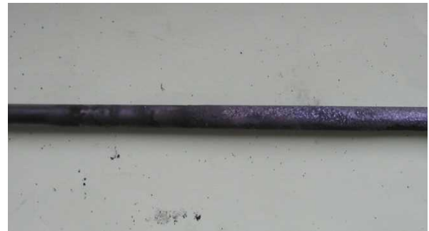
図 5.122 チオフェン:トルエン (1:1000) 水蒸気改質反応の H_2/CO (コバール) 1273K
