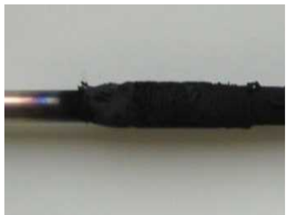
図 5.51 トルエン部分酸化後の触媒 (ハステロイ)
