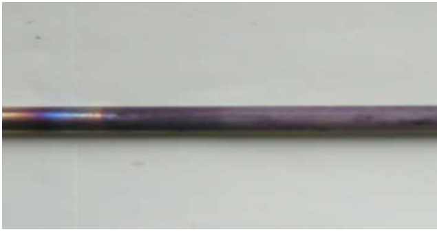
図 5.76 ナフタレン水蒸気改質反応後の反応管 (トルエン：ナフタレン=50 : 1) (ハステロイ)
