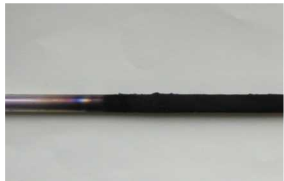
図 5.91 トルエン：チオフェン(10000：1)部分酸化反応の写真(ハステロイ)1003K
