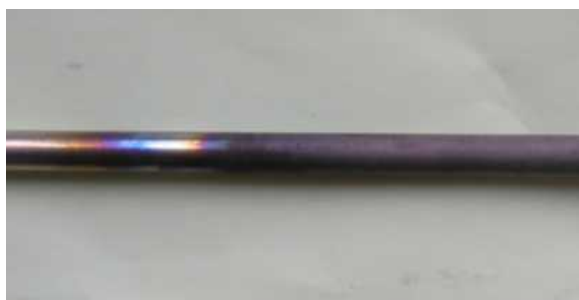
図 5.95 トルエン：チオフェン(10000 : 1) 水蒸気改質反応の写真 (ハステロイ) 1173K
