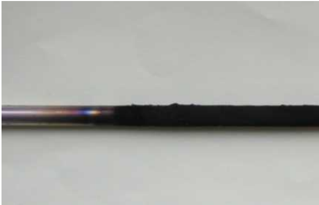
図 5.77 ナフタレン部分酸化反応後の反応管 (トル エン：ナフタレン=50 : 1) (ハステロイ)
