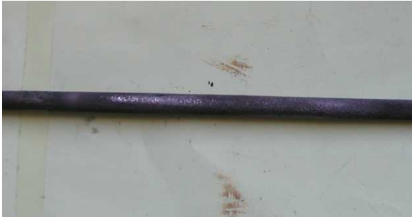
図 5.119 ナフタレン:トルエン(1:100)の水蒸気改質反応の 1273K 使用後の写真 (コバール)
