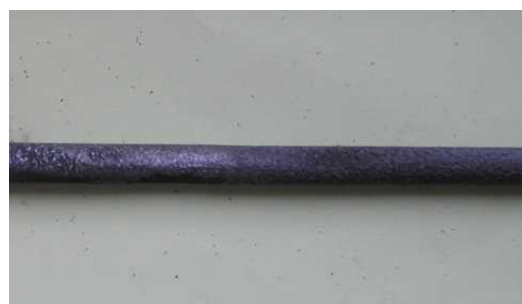
図 5.111 水蒸気改質反応(トルエン)の実験後の写真 (コバル)
