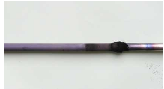
図 5.139 トルエンの二酸化炭素改質反応の使用後の写真 (コバル) 1003K
