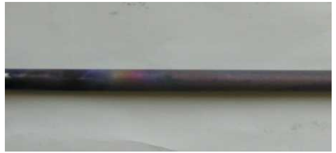
図 5.80 ナフタレン水蒸気改質反応後の反応管 (トル エン：ナフタレン=100 : 1) 1173K (ハステロイ)
