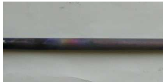
図 5.103 トルエン：チオフェン(10000：1)水蒸気改質反応の写真 (ハステロイ)3000min
