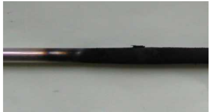
図 5.81 ナフタレン部分酸化反応後の反応管 (トル エン：ナフタレン=100 : 1) 1173K (ハステロイ)
