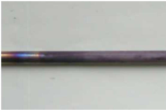
図 5.87 トルエン：チオフェン(10000：1) 水蒸気改質反応後の写真(ハステロイ)
