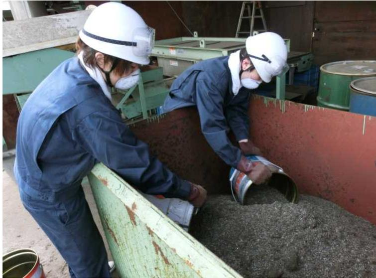
写真 5 箱型空気選別機沈下物の-2mm産物の採取状況
