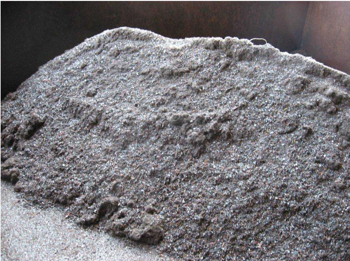
写真8 エアテーブル選別機へ投入する-2mm産物（遠景）
