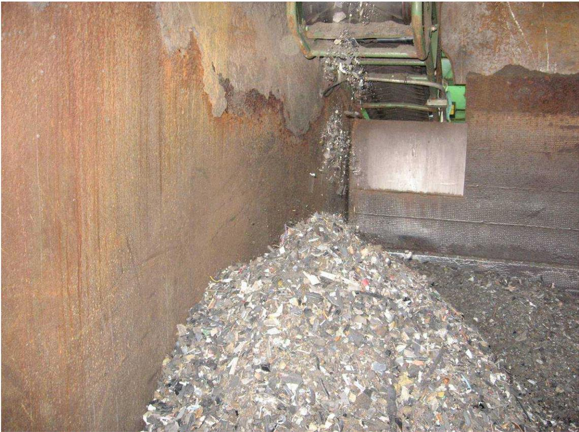
写真6 箱型空気選別機浮上産物の排出状況
