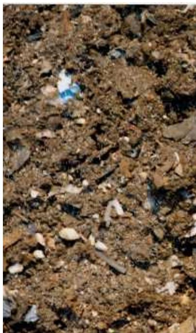
写真2 ジグザグ空気選別機軽質物（浮上物）
