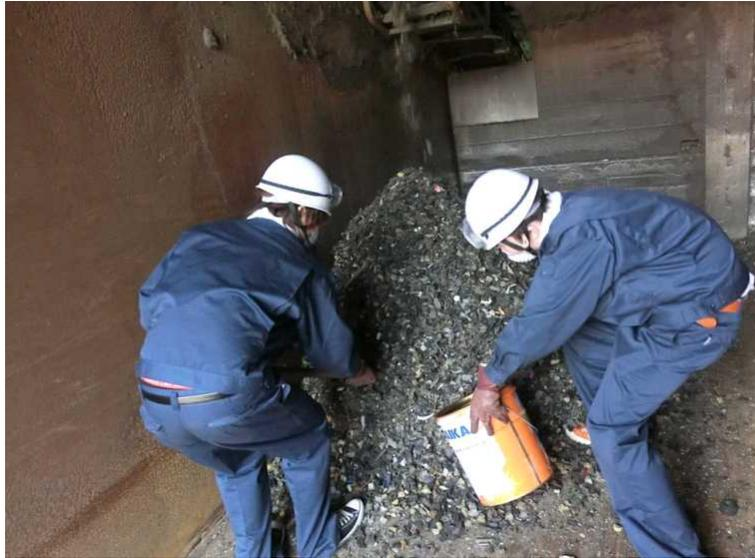
写真 4 箱型空気選別機浮上産物の採取状況
