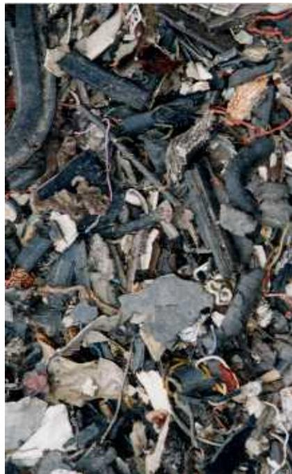
写真3 ジグザグ空気選別機重質物（沈下物）
