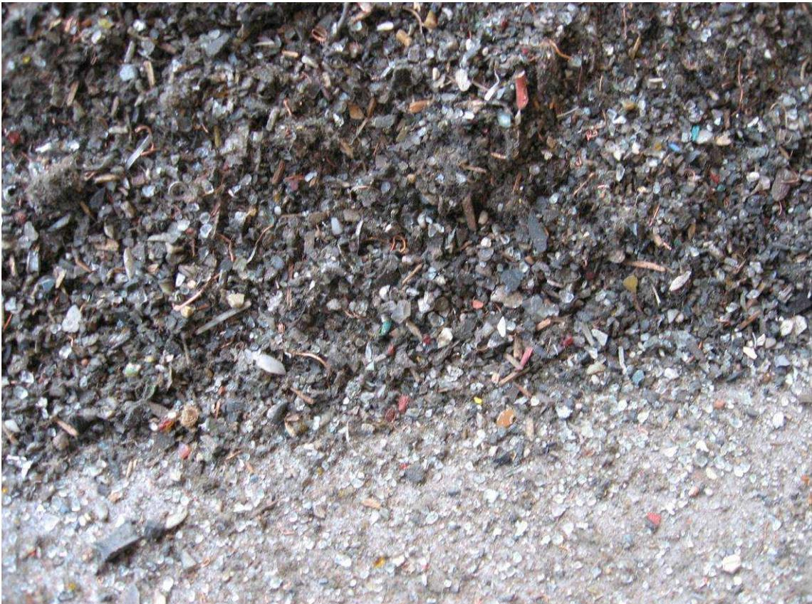
写真9 エアテーブル選別機へ投入する-2mm 産物（近景）
