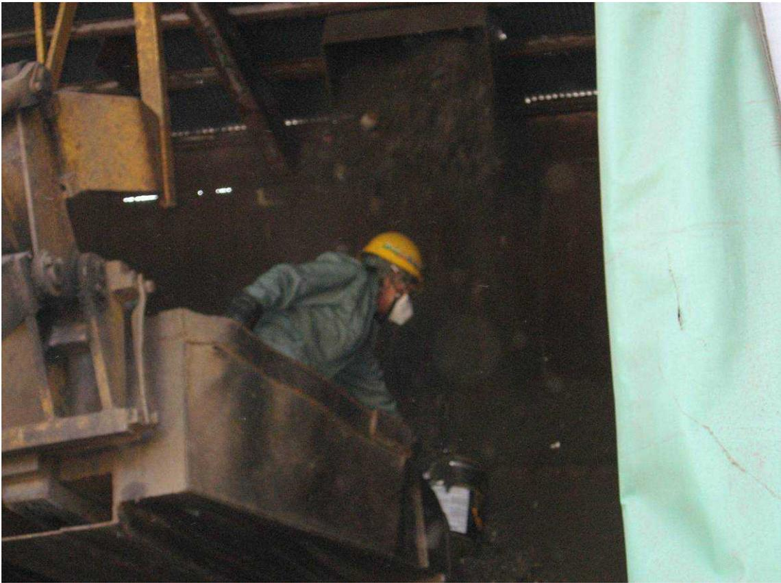
写真5 ジグザグ空気選別機浮上産物のサンプリングの様子
