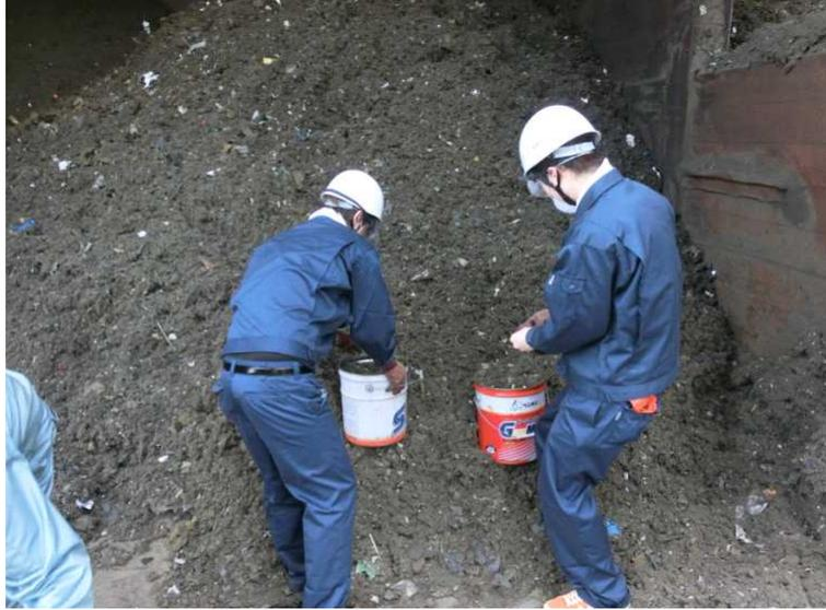
写真3 ジグザグ空気選別機浮上産物の採取状況
