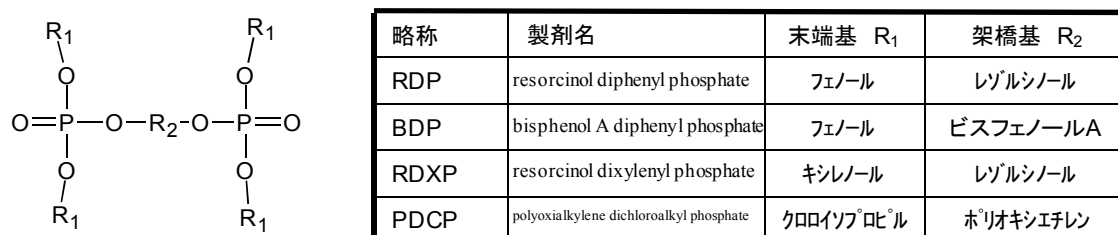
図 1. 縮合リン酸エステル類難燃剤の構造と置換基
