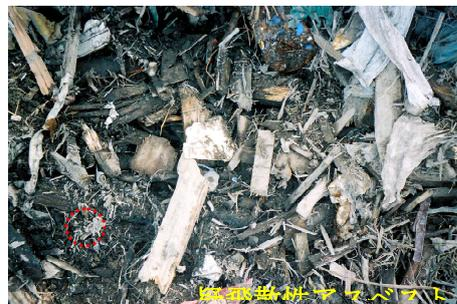
採取したスレート材、分析結果アスベスト含有建材と確認された試料 ○
