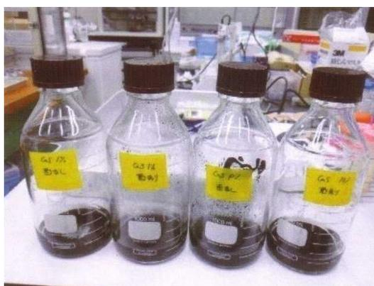
図 7.1 硫化ガス発生試験状況
