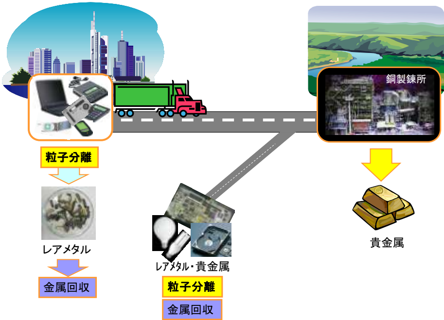
図 3.8.51 レアメタルを回収するための粒子分離(中間処理)工程の役割
