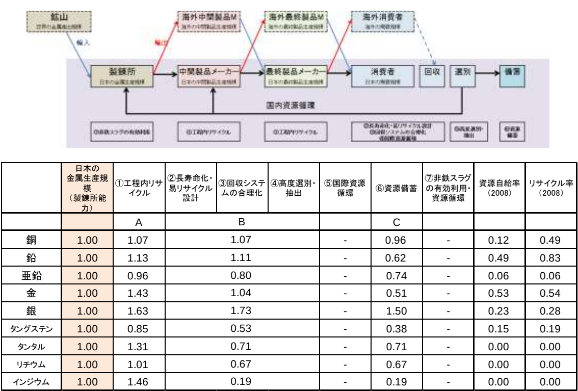
図 3.8.49 各工程における各種金属の資源循環ポテンシャル
