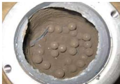
図2-18 容器上部周辺に固着した中間体 (1バッチ180g)
