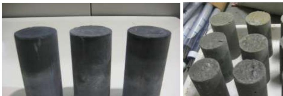
図2-24 セメント固化体とコンクリート固化体
