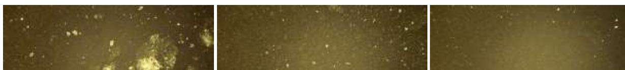
図2-9 ボール径の違いによる硫化物の均一性の違い (デジタルマイクロスコープ画像)
