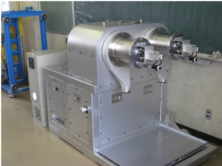
図17 コンバージミル連続粉碎装置(内容積6L+3L)
