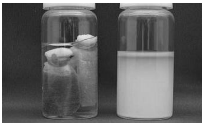
図2 イオン交換樹脂を用いた石膏の溶解挙動(左:イオン交換樹脂あり, 右:なし)
