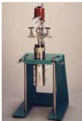
図 1-3-7 前処理に使用した反応装置（耐圧硝子工業株式会社、<http://www.taiatsu.co.jp/products/index.htm>）
