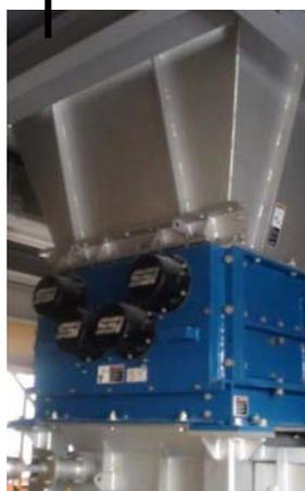
写真-5.3 4軸破碎機
