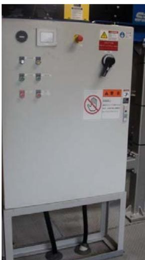
写真-5.4.1 ① 破碎機操作盤
