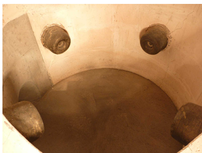
写真 50 耐火物乾燥後の炉内（炉底）
