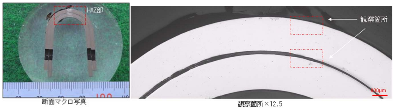
図2.2 溶接および応力負荷部断面ミクロ観察
