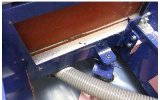
写真-5.3.3 圧縮された袋内空気の噴出による粉じん飛散状況の例
