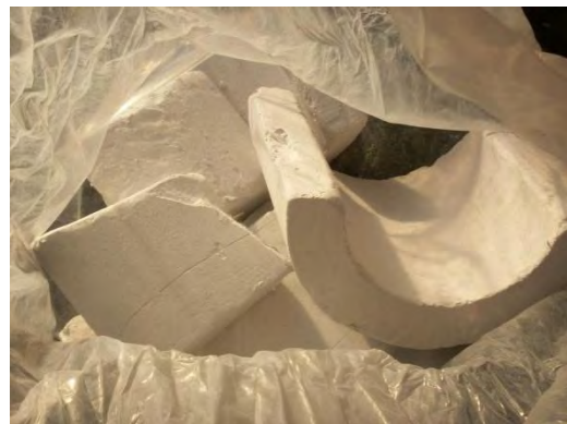
写真-3.5.8 試験に用いた配管保温材
