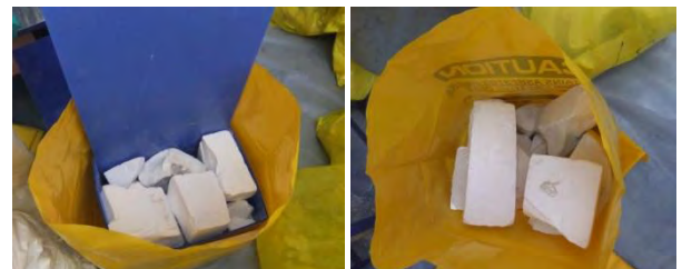
a) 詰込状況 b) 補助器具を抜いた状況 写真-3.3.10 袋詰め補助器具 (中袋用)
