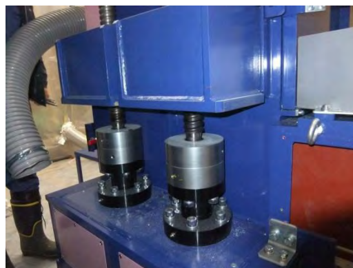
写真-4. 2. 4 減容化装置 (ボールねじ部下端) 加圧版を降ろしきった状態
