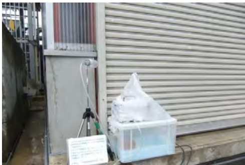
写真-5.3.36 大気サンプル採取(シャッター前)
