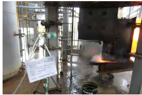
写真-5.3.33 大気サンプル採取(湯口付近)
