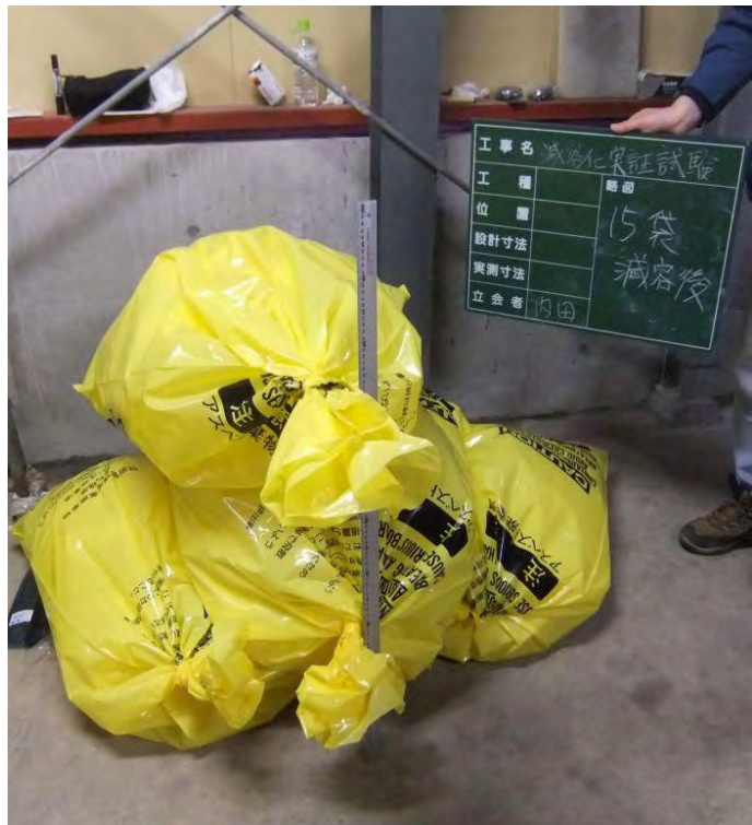
写真-5.3.24 試験体(4 体)大ビニル袋詰、グースネック縛り
