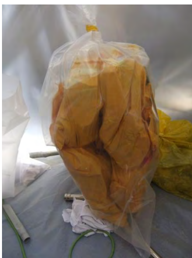
写真-5.3.21 試験体(4体)大ビニル袋詰、グースネック縛り後に立てた状態
