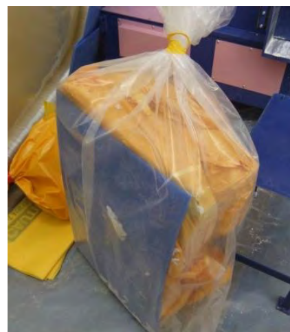
写真-5.3.24 試験体(4 体)大ビニル袋詰、グースネック縛り
