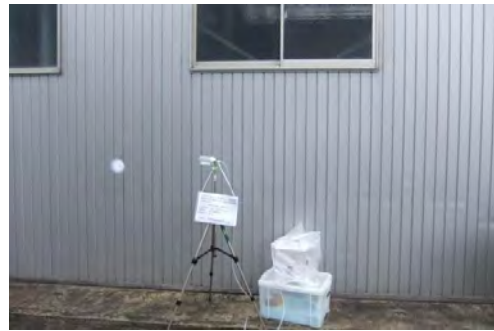
写真-5.3.35 大気サンプル採取(窓下)
