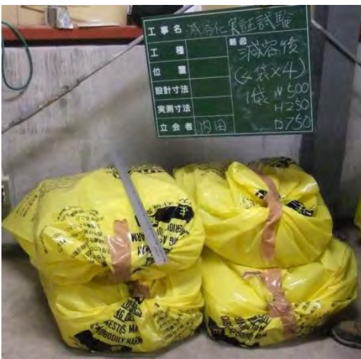
写真-5.3.23 試験体(4 体)圧縮後の大ビニル袋詰 状況 長方形形状維持を意識した場合
