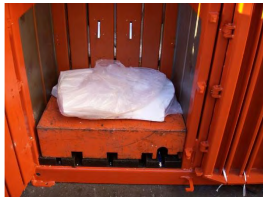
写真-3.5.10 減容化後の状況
