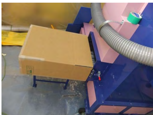
写真-5.3.25 試験体(4体)圧縮後のダンボール箱詰状況 排出口に直接ダンボール箱を設置
