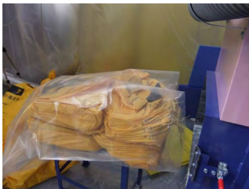
写真-5.3.19 試験体(4体)圧縮後の大ビニル袋詰状況
