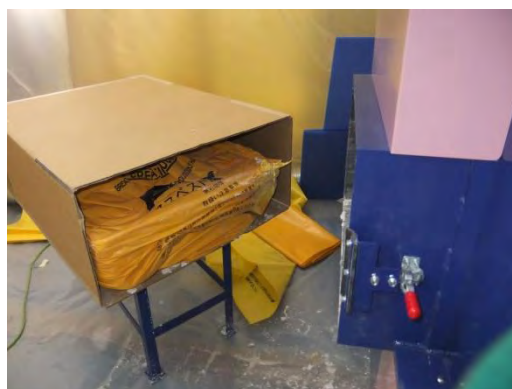
写真-5.3.26 試験体(4体)圧縮後のダンボール箱詰状況 ダンボール箱に圧縮後の保温材が入った状況
