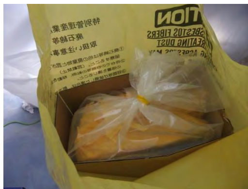
写真-5.3.28 試験体(4体)圧縮後のダンボール箱詰状況 大サイズビニル袋入れした保温材をダンボール箱入れして2重目のビニル袋入れした状況
