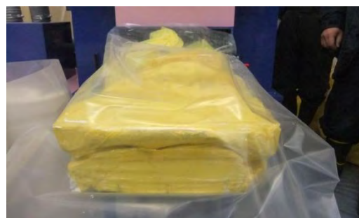
写真-5.3.11 試験体(4体)一括減容化後の排出状況
