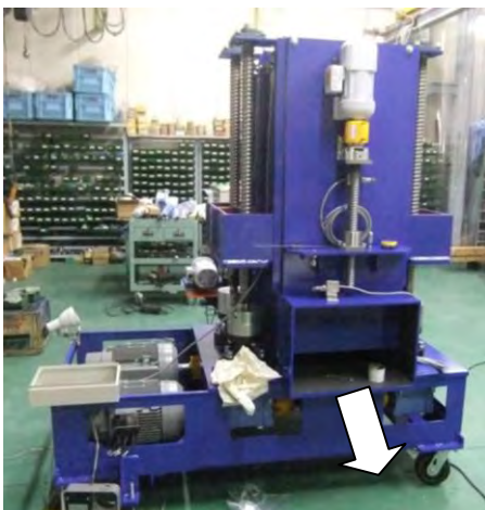
写真-5.3.4 排出口側の隙間
