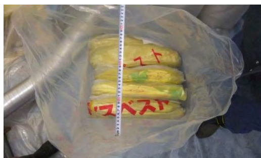
写真-5.3.10 試験体(4体)圧縮後の大ビニル袋詰状況
