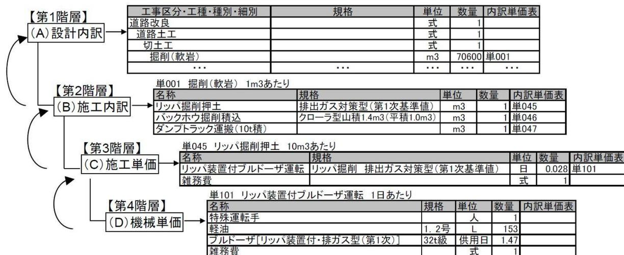
図 66 工事積算書のデータ構造 (イメージ)
