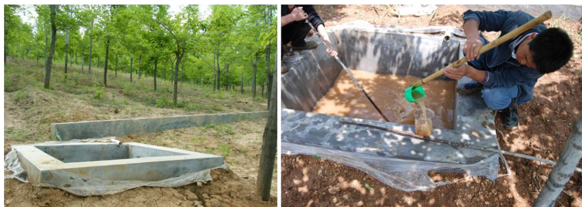
図2-3 トチュウ林における土壌侵食量測定プロット（左）と土壌流出量実測の様子（右）
