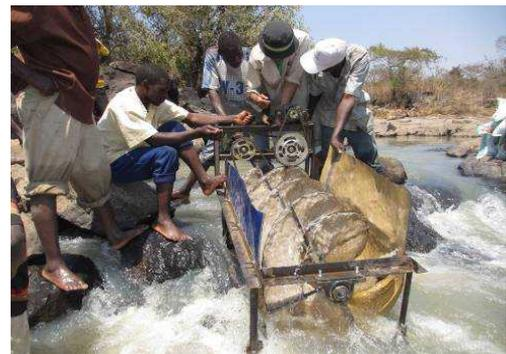
写真(2)-10 らせん水車による水力発電
