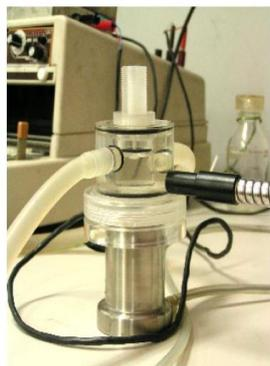
図5 クラーク型酸素電極
