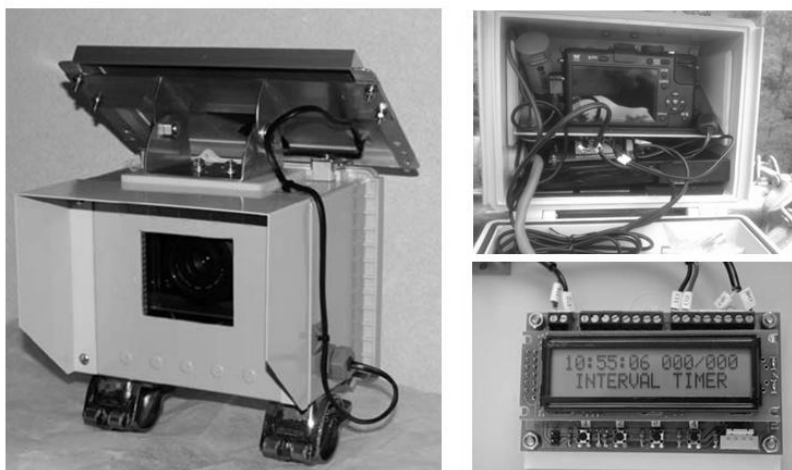
図(2)-23コンパクトカメラによる自動撮影カメラ(左)、内部(右上)、制御ボード(右下)
