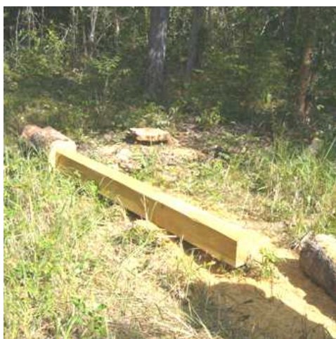
写真(1)-1 立木はチェーンソーにより伐倒、野外で製材される。樹種は Erythrophleum succirubra
