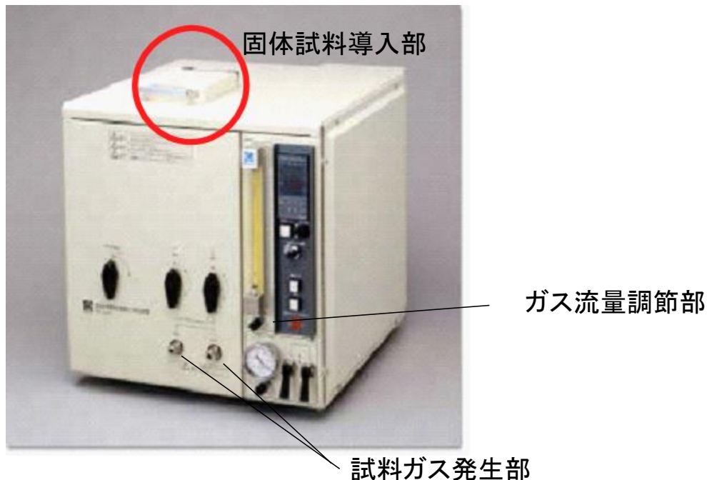
図(3)-1 校正用ガス調整装置(パーミエーター)
