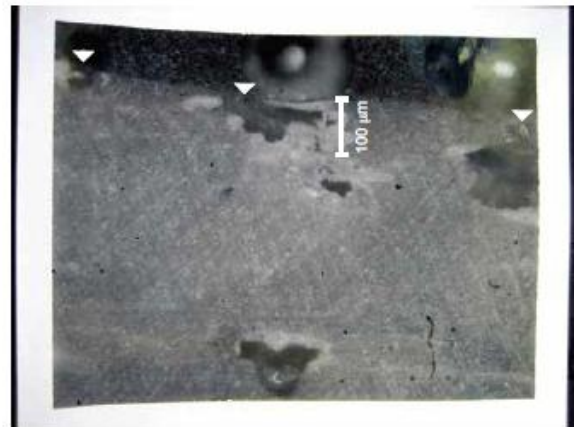
図(2)-5 新品にやすりで傷をつけたフロート(a)と、海岸に漂着したフロート(b)の顕微鏡断面写真。目立った傷の個所に白い三角形を配置し、スケールを描き入れた。
