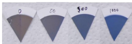
図(2)-5 クロムアズロールS/Latex-NR 3 + 膜によるクロム(III)の検出 定量範囲は約30~2,000 ppbである。
