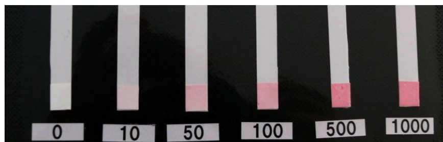
図(2)-9 バソフェナントロリンスルホン酸/Latex-NR 3 + 膜による鉄(II)の検出
