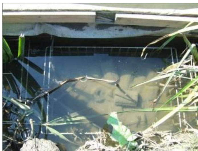
図(2)-8(a) 円筒型水質浄化モジュールの底泥蓄積状況
