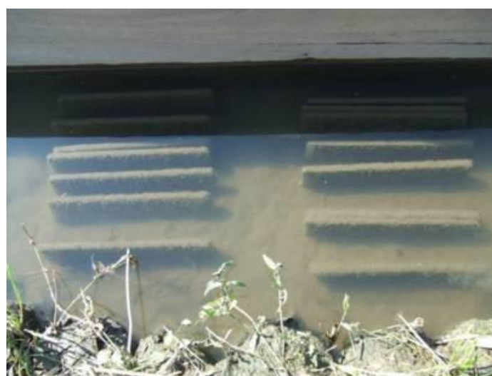
図(2)-8(b) 平板型水質浄化モジュールの底泥蓄積状況
