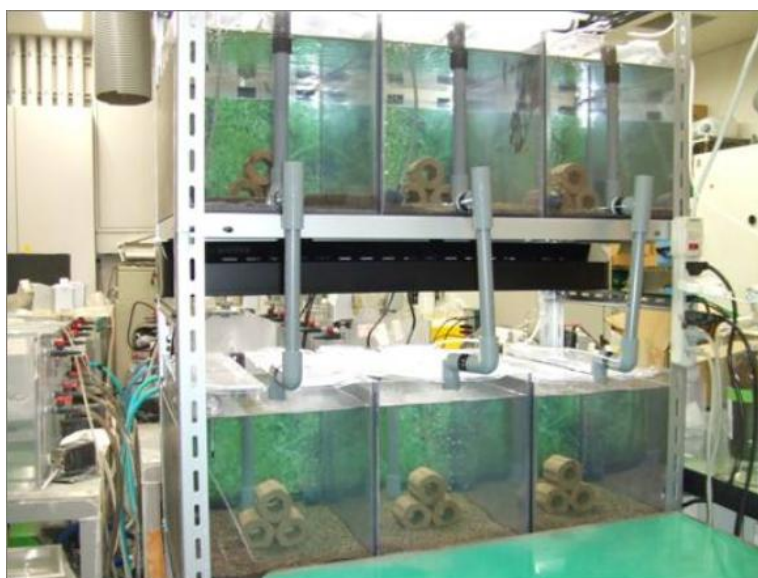
図(3)-3 水槽を用いた産卵実験装置
