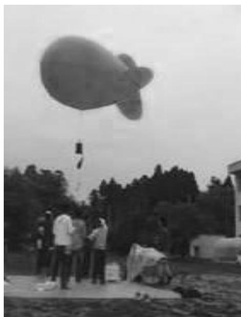
図(4)-1 係留気球を用いたサンプリング
